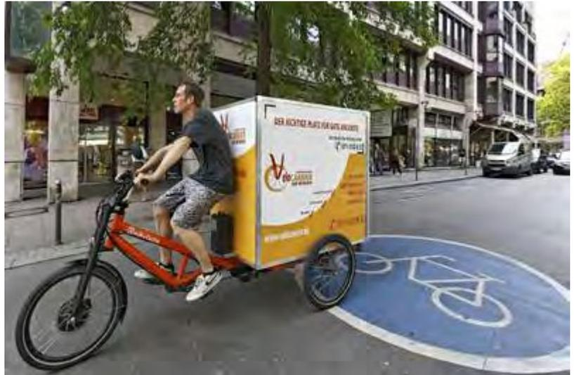
Velocarrier-Dreirad, ausgelegt für 250 Kilogramm Spitzenlast.
