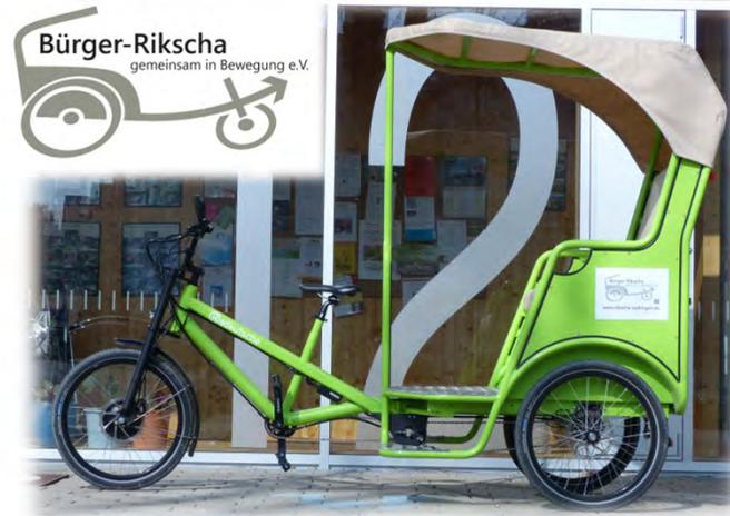
Und das hier ist **unsere RIKSCHA**. Das Modell **Musketier** des Herstellers Radkutsche mit Rikscha-Aufbau und elektrischem Hilfsmotor für einen Fahrer und zwei Fahrgäste. Mit Dach, kleinem Stauraum und der Möglichkeit zur Mitnahme von 2 klappbaren Rollatoren
